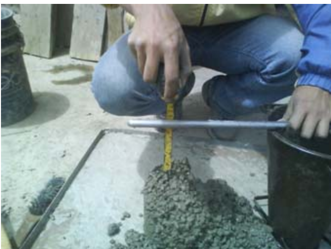
Foto 11. Asentamiento final con superplastificante 25%
