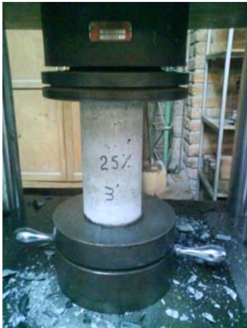
Foto 29. Ensayo a compresión en probeta 3 con el 25% de puzolana y resultado del mismo. (29589Kgf)
