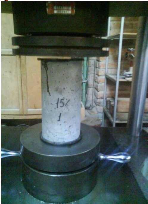
Foto 21. Ensayo a compresión en probeta 1 con el 15% de puzolana y resultado del mismo. (36227Kgf)
