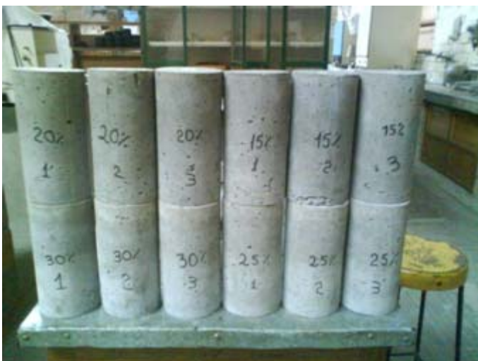
Foto 17. Todas las probetas después del curado
