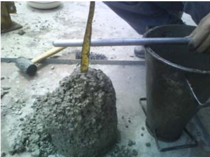
Foto 10. Asentamiento final con superplastificante 20%
