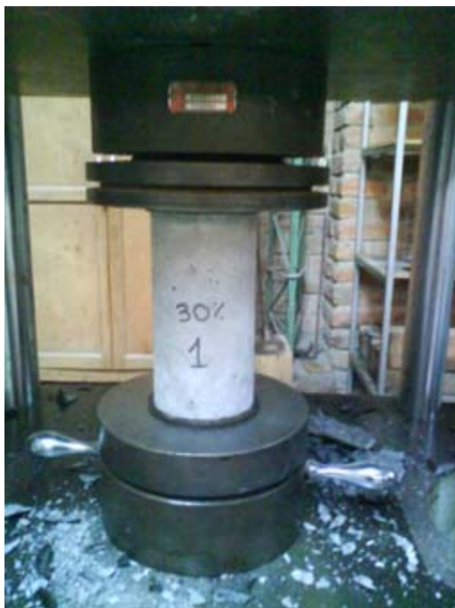
Foto 30. Ensayo a compresión en probeta 1 con el 30% de puzolana y resultado del mismo. (30106Kgf)
