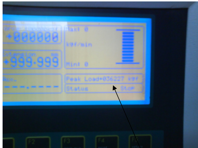
Foto 21. Ensayo a compresión en probeta 1 con el 15% de puzolana y resultado del mismo. (36227Kgf)
