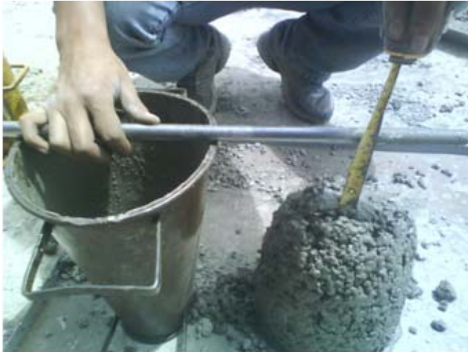
Foto9. Asentamiento final con superplastificante 15%
