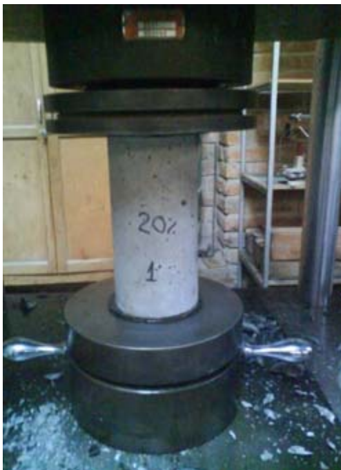
Foto 24. Ensayo a compresión en probeta 1 con el 20% de puzolana y resultado del mismo. (38770Kgf)
