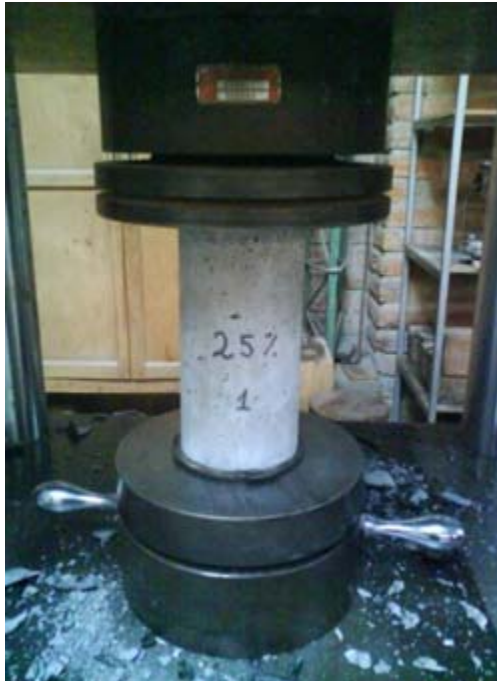
Foto 27. Ensayo a compresión en probeta 1 con el 25% de puzolana y resultado del mismo. (34164Kgf)
