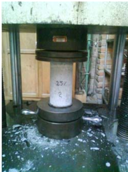
Foto 28. Ensayo a compresión en probeta 2 con el 25% de puzolana y resultado del mismo. (34164Kgf)
