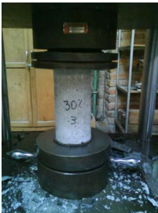
Foto 32. Ensayo a compresión en probeta 3 con el 30% de puzolana y resultado del mismo. (25775Kgf)
