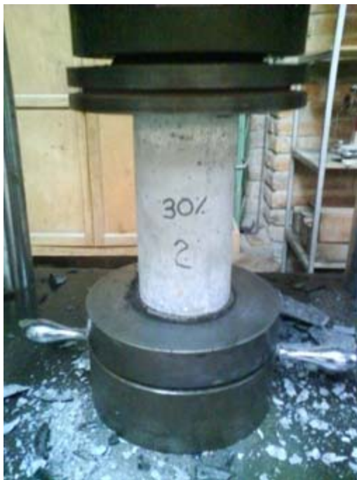
Foto 31. Ensayo a compresión en probeta 2 con el 30% de puzolana y resultado del mismo. (28154Kgf)
