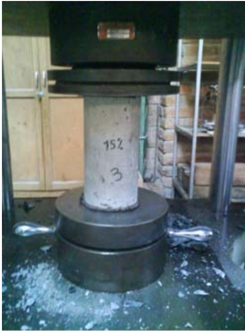
Foto 23. Ensayo a compresión en probeta 3 con el 15% de puzolana y resultado del mismo. (36350Kgf)
