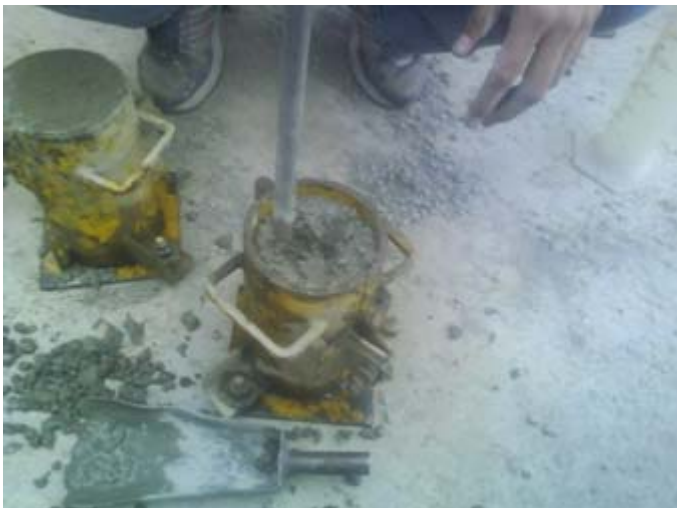
Foto 13. Fabricación de las probetas dando 25 golpes cada capa (3 capas)
