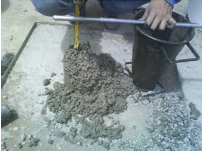
Foto 12. Asentamiento final con superplastificante 30%
