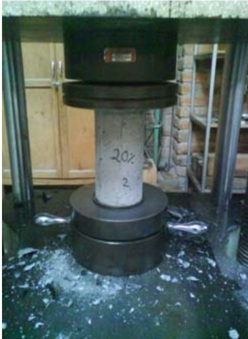
Foto 25. Ensayo a compresión en probeta 2 con el 20% de puzolana y resultado del mismo. (41503Kgf)
