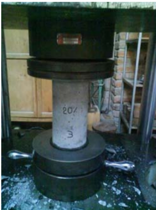
Foto 26. Ensayo a compresión en probeta 3 con el 20% de puzolana y resultado del mismo. (38756Kgf)
