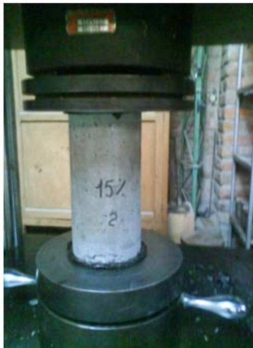
Foto 22. Ensayo a compresión en probeta 2 con el 15% de puzolana y resultado del mismo. (36479Kgf)
