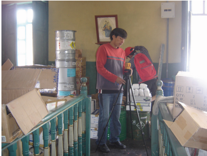
Proceso de nivelación con nivel digital.
