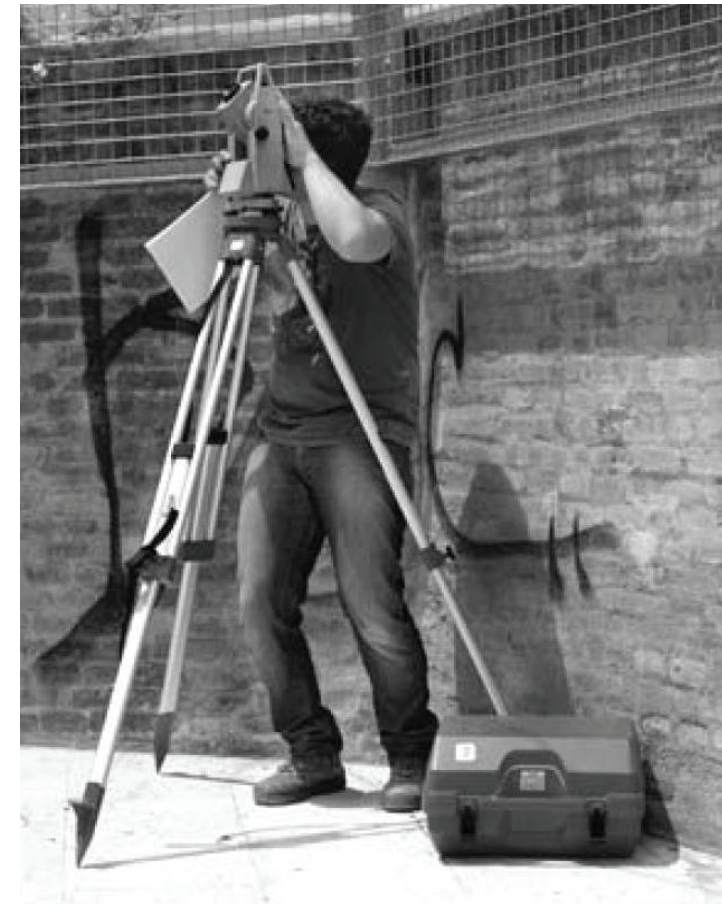
Estudiante realizando el levantamiento con el distanciómetro láser
