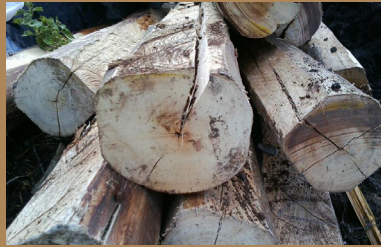
figura 41. Perforaciones* Defectos de crecimiento
