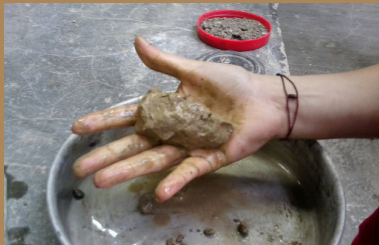
figura 196. Muestra compacta* P. compresión de la muestra
