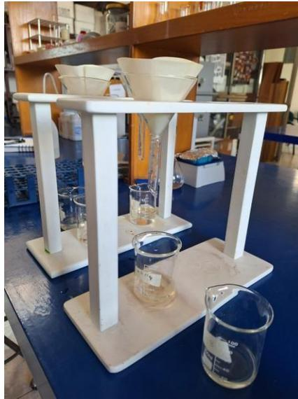
**Figura 14.** Montaje para la separación de agua residual de microalgas mediante filtración.
