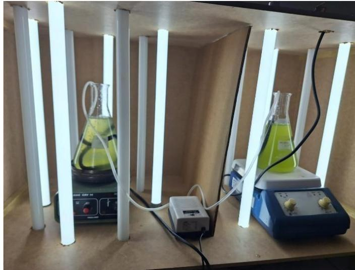
**Figura 9.** Montaje experimental del fotobiorreactor implementado.
