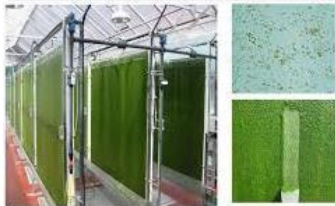
**Figura 3.** Tratamiento de microalgas mediante inmovilización pasiva
