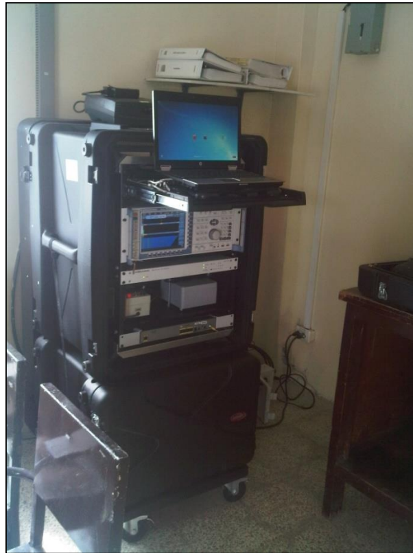
Gráfica 1. 4. Estación Remota Transportable
