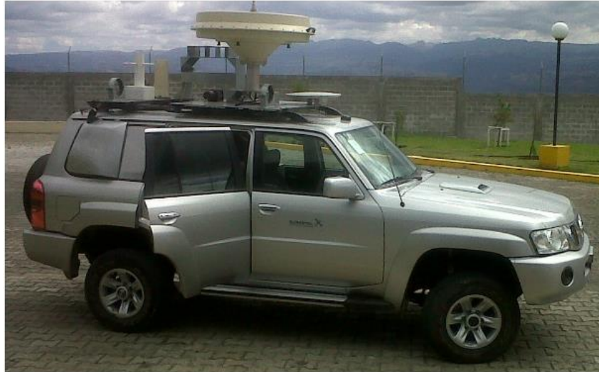
Gráfica 3. 42. Estación Móvil para la realización de la Cobertura de Radio y TV.
