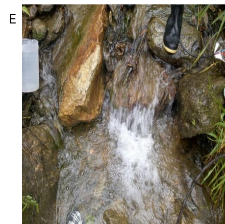
FOTO A 4.1: Puntos de aforo. A, B, D, E puntos 3, 4, 6 y 25 respectivamente; aforados con el método volumétrico. C, punto 5, aforado con el método del molinete. F, punto 11, aforado con el método del flotador.
