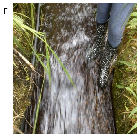
FOTO A 4.1: Puntos de aforo. A, B, D, E puntos 3, 4, 6 y 25 respectivamente; aforados con el método volumétrico. C, punto 5, aforado con el método del molinete. F, punto 11, aforado con el método del flotador.
