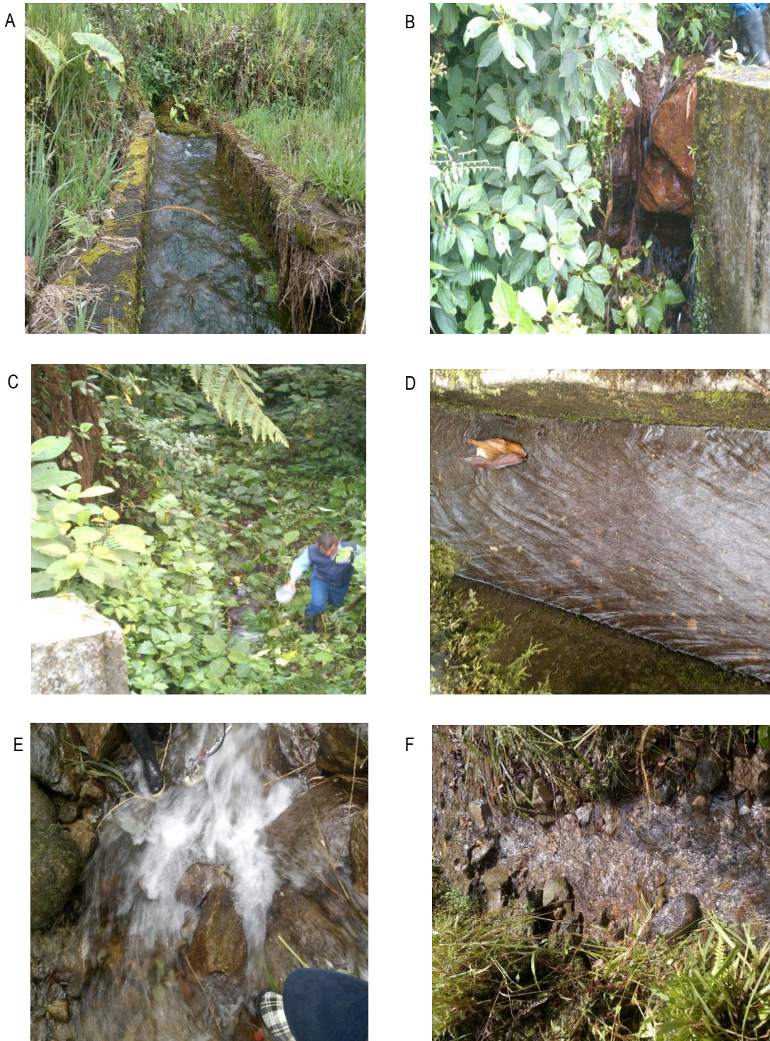
FOTO A 4.2: Puntos de aforo. A, D, F puntos 10, 27 y 16 respectivamente; aforados con el método del flotador. B, C, puntos 12 y 13 respectivamente; aforados con el método volumétrico. E y F, puntos 8 y 16 respectivamente; aforados con el método del molinete.
