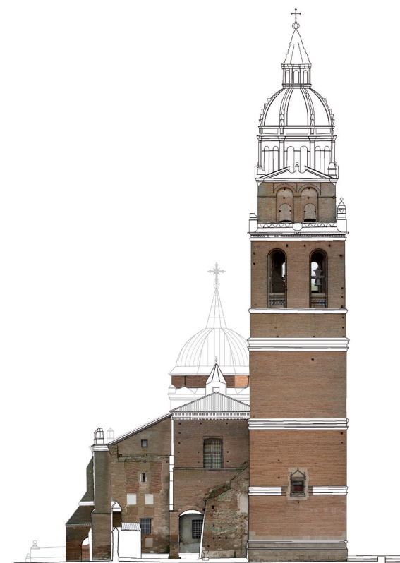
FIG. 16. Ejemplo de documentación que contribuye con la representación del material de una de las fachadas de la iglesia de Santa María (Alaejos), mediante ortofotografía.
