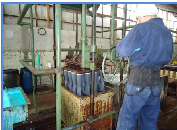
Posteriormente al salir del coagulante de agua se sumerge en el látex verde y nuevamente al coagulante de agua, para someterlos al enrollado, todo este proceso se hace manualmente.
