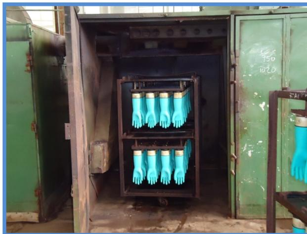
Todo este proceso tiene una continua supervisión, dado el visto bueno en cuanto a la calidad y el peso del guante pasa al proceso de clorinado por 45 minutos, ya que este paso ayuda a que el guante no se pegue; por último se lo lava y se lo escurre para mandarlo a la secadora con una temperatura de 70 grados en un tiempo de 12 horas, obteniendo así el producto terminado, inmediatamente el guante se manda a la bodega con las respectivas observaciones en cuanto a la supervisión del producto.
