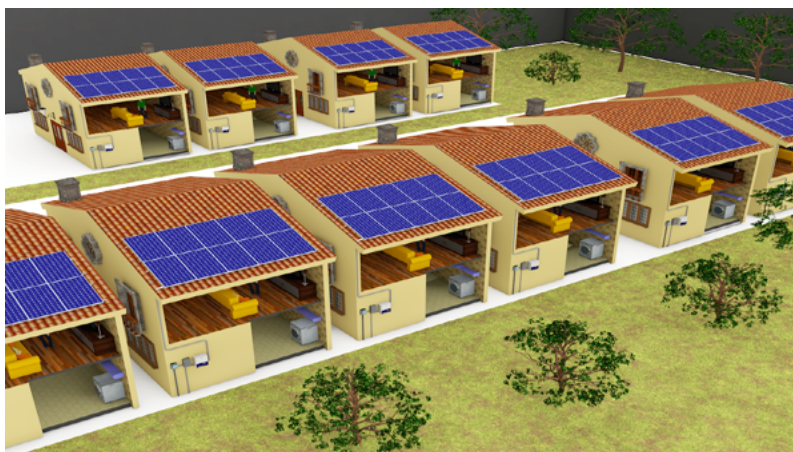
Figura 49. Paneles fotovoltaicos en cubierta de viviendas Fuente [elaboración propia]
