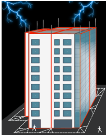
Figura 41. Protección mediante jaula de Faraday Fuente [elaboración propia]
