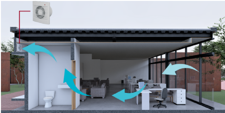
Figura 67. Ventilación por depresión Fuente [elaboración propia]
