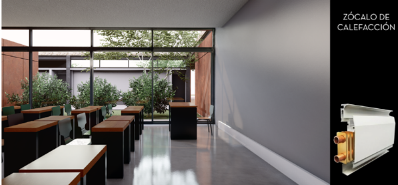
Figura 28. Calefacción por zócalos Fuente [elaboración propia]
