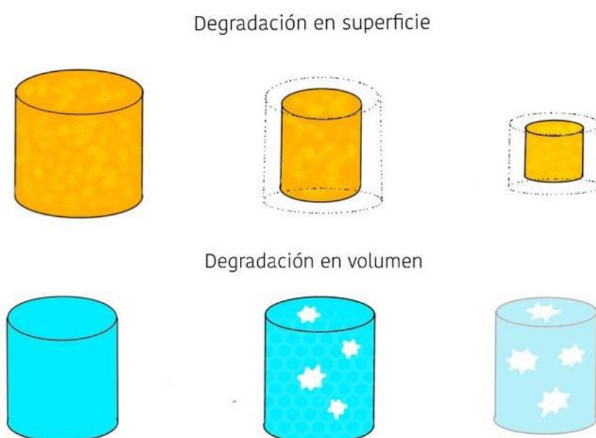
Figura 2: Tipos de degradación hidrolítica del material de sutura.
