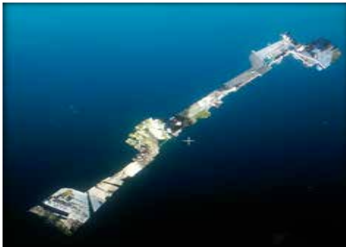
Figura 14. Nube de puntos TLS a lo largo del eje longitudinal del deslizamiento UDA.
