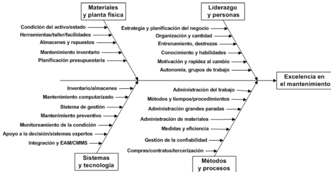
Figura 38. Ejemplo de diagrama causa-efecto.
