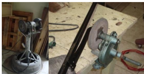
Foto 3.2.3.18.E. Equipo Sin Protección
