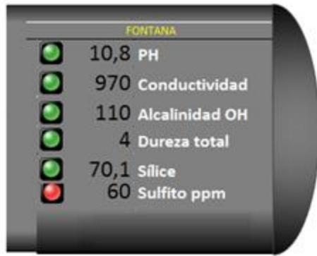
**Figura 5.5** Esquema del sistema gráfico que representa a una caldera y sus parámetros con la señalización respectiva.
