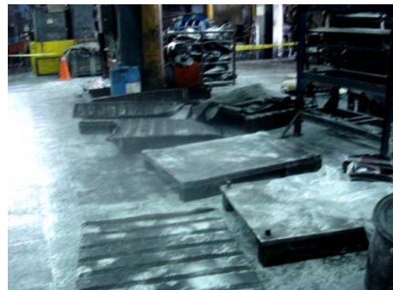
Fig.2.7 Suciedad en el área por derrames de talco.
