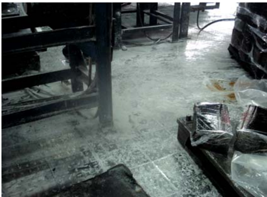
Fig.2.6 Suciedad en el área por derrames de talco.
