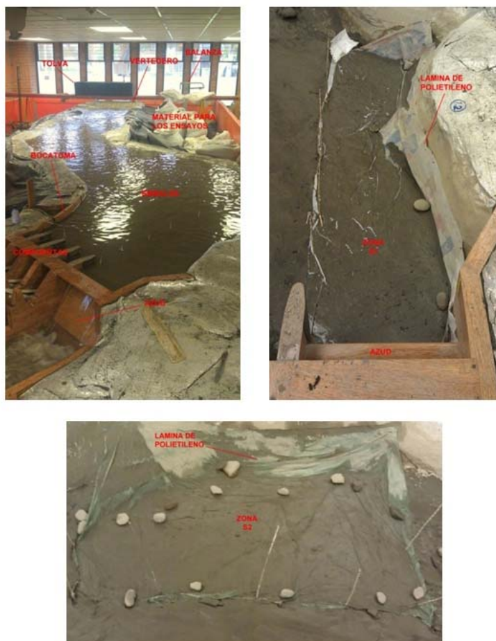
Figura 3.4.4: Materiales y Equipos usados durante los ensayos de discriminación de material sedimentado en el modelo físico
