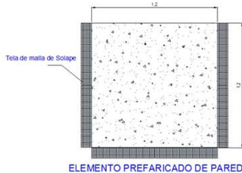
.Para la prefabricación de los elementos se debe seguir las recomendaciones del ACI 350 de ferrocemento:
