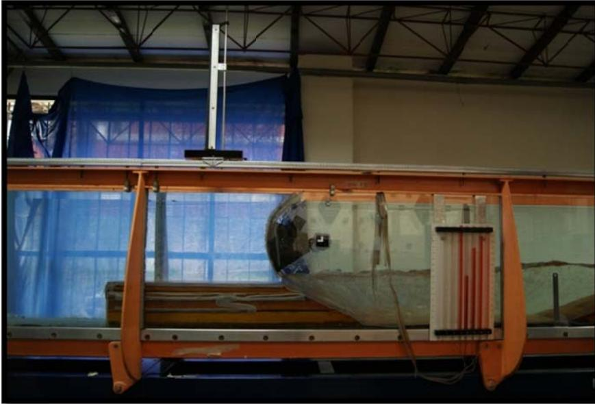
1.a) La compuerta se encuentra en  $P = 1$ ,  $z = 2$  y  $Q = 13.42$  L/s, equivalente a  $400$  m<sup>3</sup>/s en prototipo. Se observa una pequeña abertura en la compuerta,  $a = 0.5$  cm; por lo cual la carga de agua sobre la compuerta es elevada, mayor a
