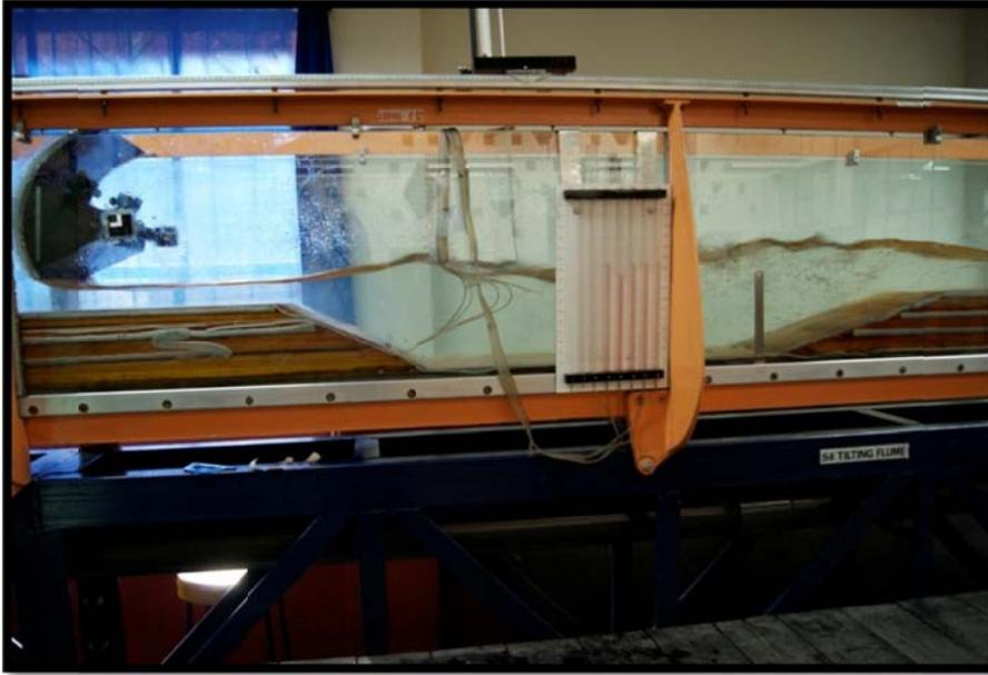
1.c) La compuerta se encuentra en  $P = 3$ ,  $z = 2$ .  $H = 20.60$ .  $Q_m = 20.12$  L/s ( $Q_p = 600 \text{ m}^3/\text{s}$ ).  $a = 5.80$  cm. La abertura es igual a 5.80 cm. Se observa la formación de hoyas a la altura del cuenco dissipador.
