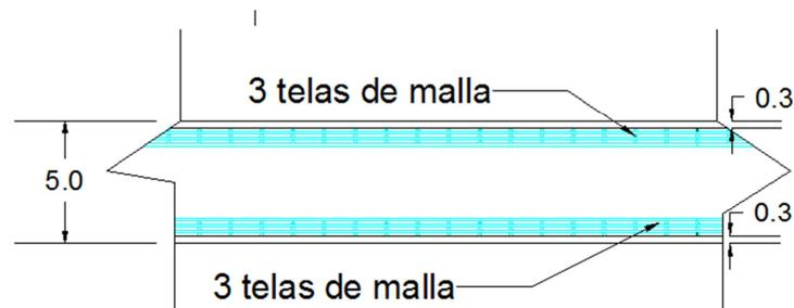
Figura 29 Detalle de losa de fondo. En centímetros.
