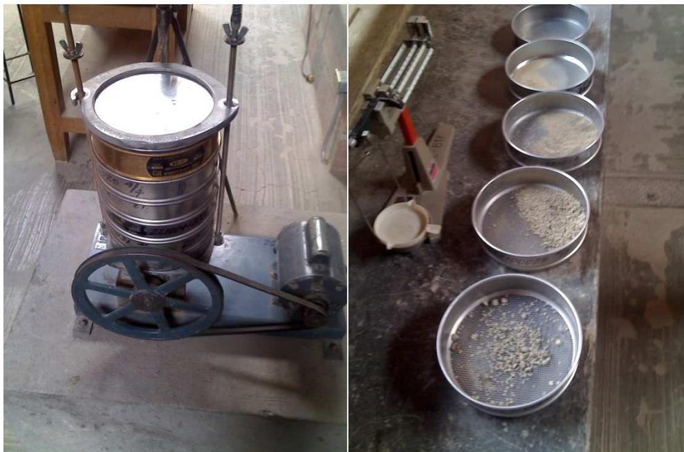
*Se tamiza la arena a utilizar con el fin de obtener su módulo de finura y el tamaño de las partículas.*
