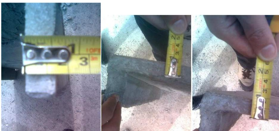
*Por ultimo se comprueba que los espesores cumplan con las medidas especificadas .*
