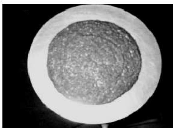
*Figura 20. Consistencia del mortero para ferrocemento. [Bedoya, 1996]*
