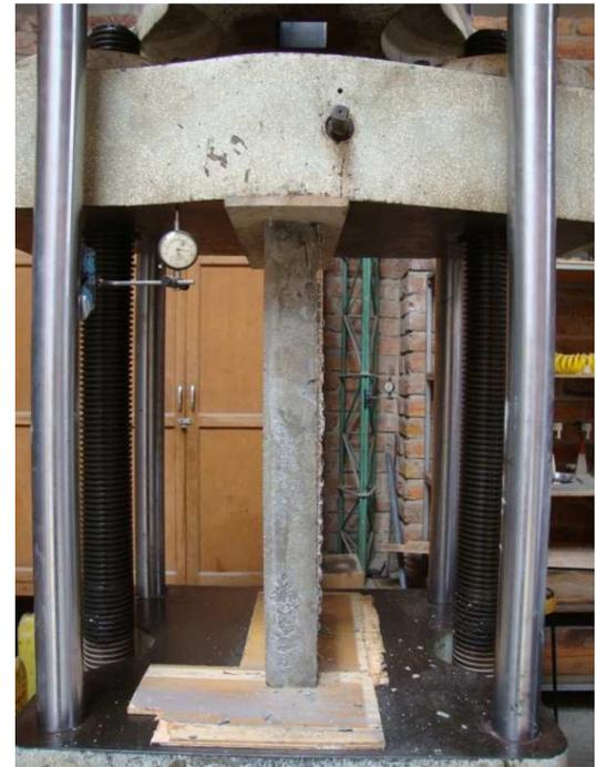
*Se ubican los elementos correctamente en la prensa para garantizar que trabajen adecuadamente.*
