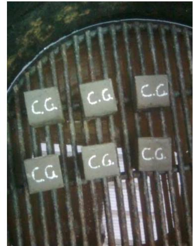
*Se sacan las respectivas muestras para comprobar la resistencia a compresión del mortero.*
