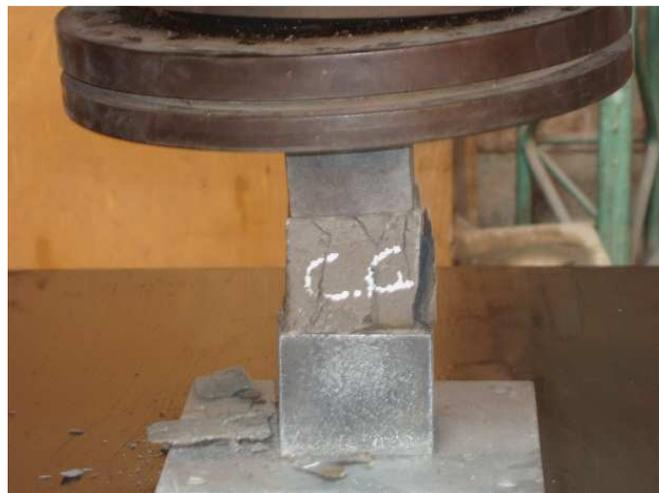
*Se procede a la compresión de los elementos hasta su rotura.*
