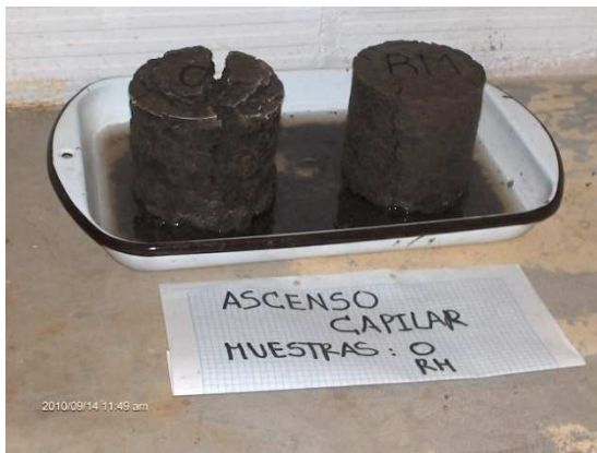
Muestra O sufre daño.
