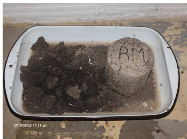
Al cabo de varios días, muestra RM no sufre daño.
