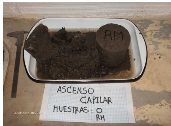
Muestra O se desmorona, RM intacta.
