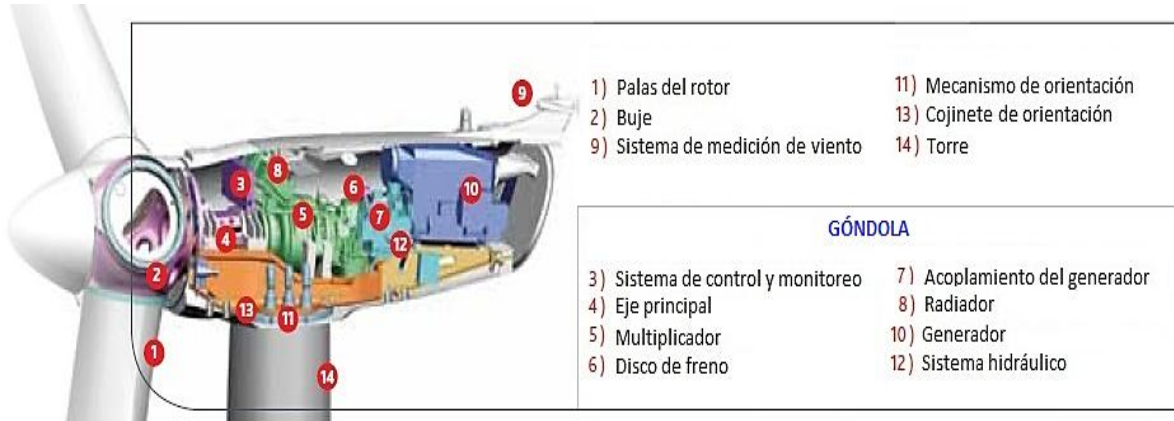
Figura 3. 11 Principales componentes de un aerogenerador
