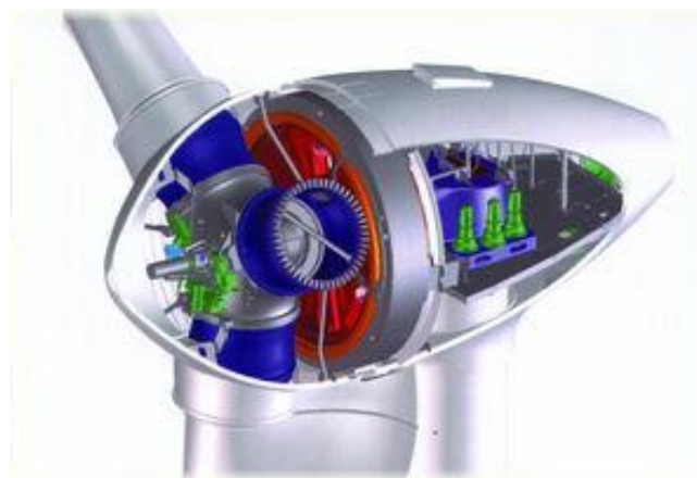
Figura 3. 13 Aerogenerador sin caja multiplicadora
