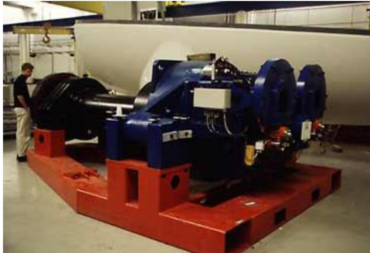
Figura 3. 12 Caja multiplicadora para aerogenerador de 1,5 MW
