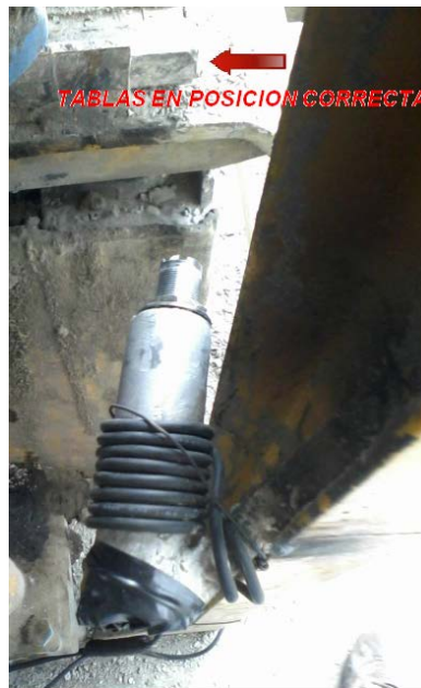
Figura 3.13. Sensor de posicionamiento correcto de tablas.
