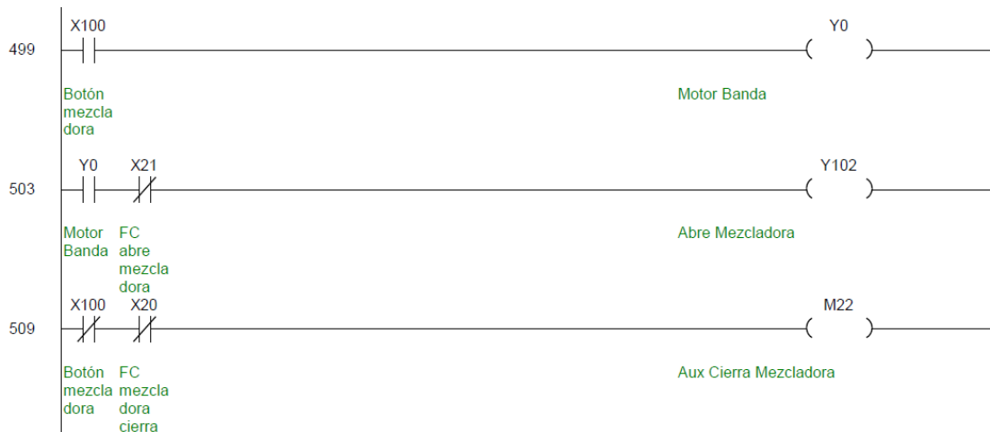
Figura 3.18. Control manual del motor banda de la banda transportadora y pistones de apertura y cierre de portezuela de mezcladora.
