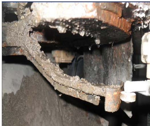
Figura 3.7. Mecanismo que activa y desactiva el sensor.
