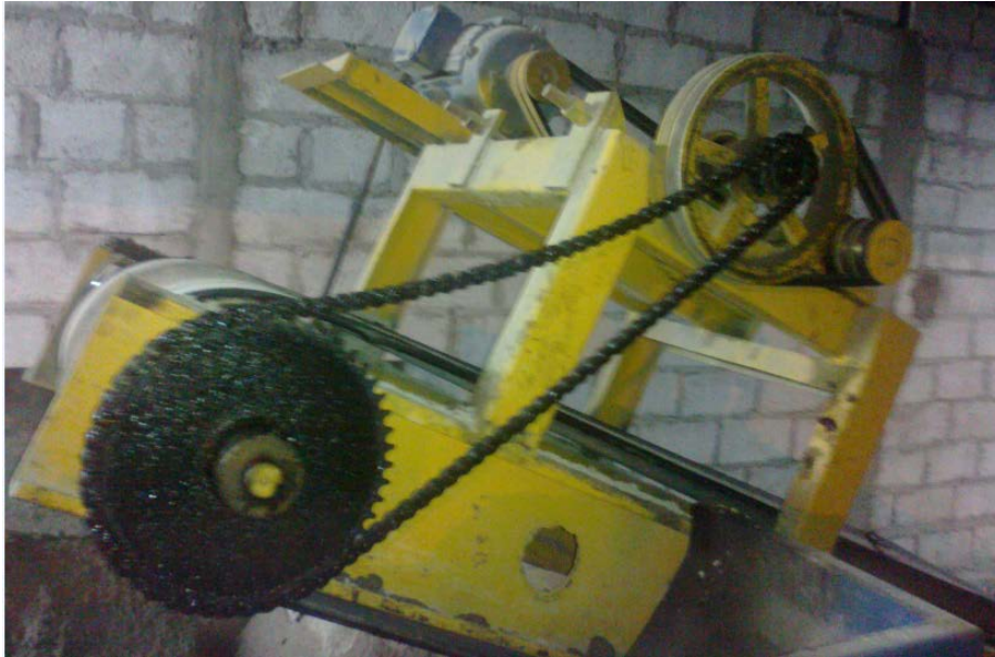
Figura 1.23. Motor con conjunto de catalinas que hace girar la banda transportadora.
