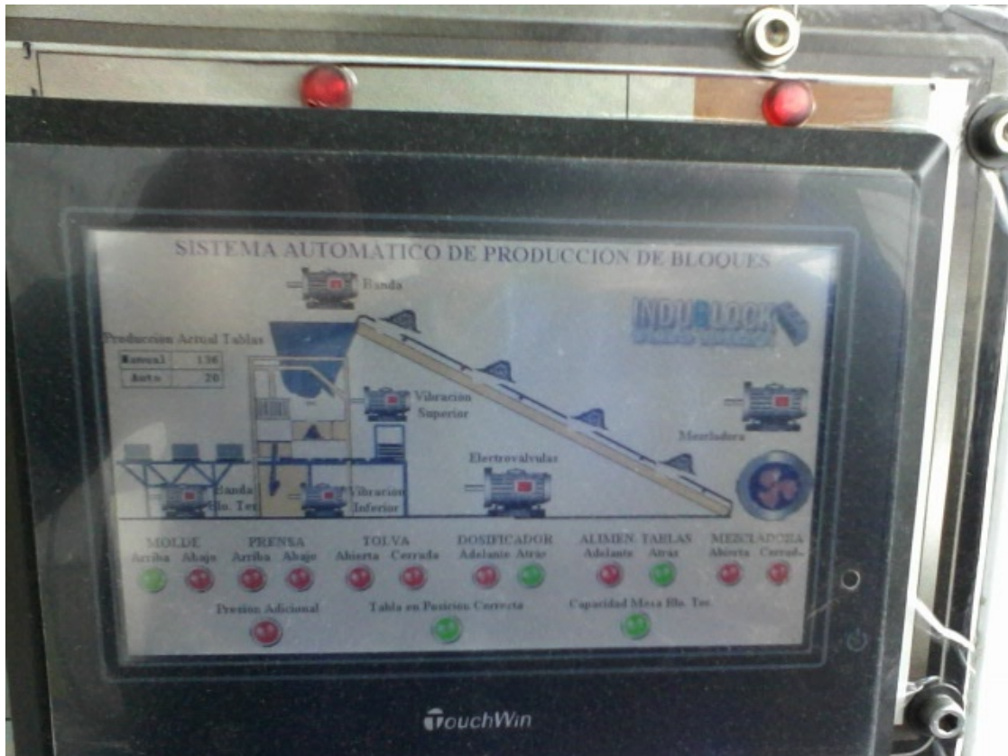
Figura 3.38. Ventana “de funcionamiento” del HMI online.
