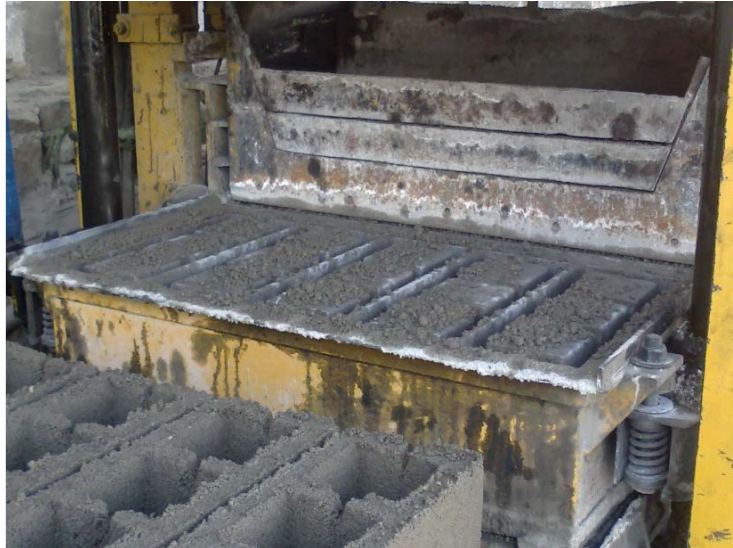
Figura 1.31. Molde esperando carga del dosificador.
