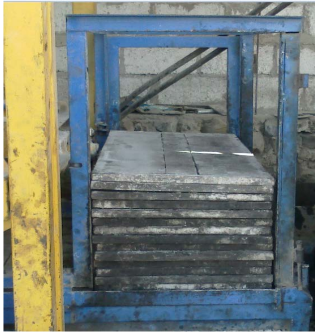
Figura 1.33. Surtidor de tablas.
