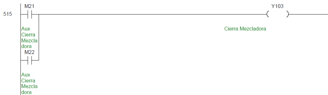
Figura 3.31. Contactos auxiliares dentro del programa que activan el cierre de la mezcladora.
