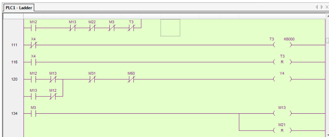
Figura D6. Programación en forma de chart (escalera).
