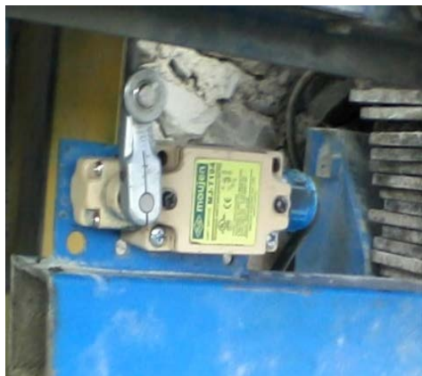
Figura 3.10. Sensor de posicionamiento de tablas adelante.
