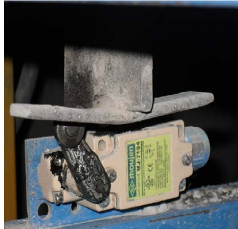
Figura 3.11. Sensor activado (desarmado).
