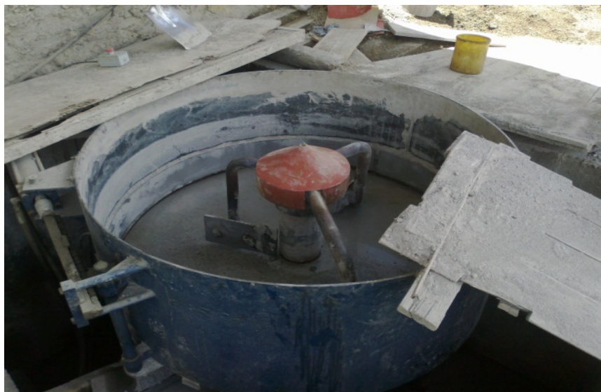
Figura 1.18. Paletas de la mezcladora.
