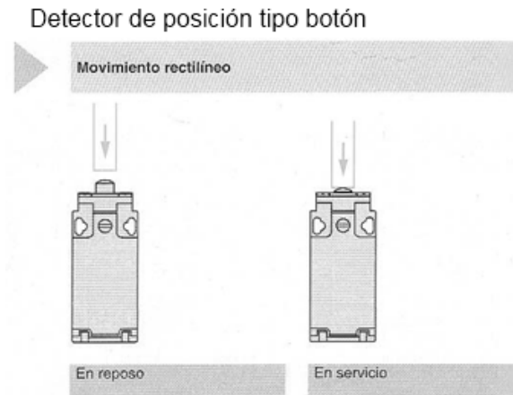
Figura C1. Interruptor de posición que se instalará en el pistón de tablas.
