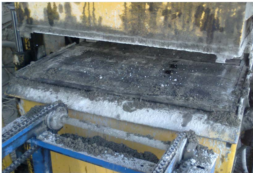
Figura 1.37. Tabla sobre plancha de vibración.
