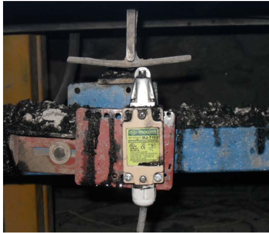
Figura 3.9. Sensor de pistón de tablas (atrás) activado.
