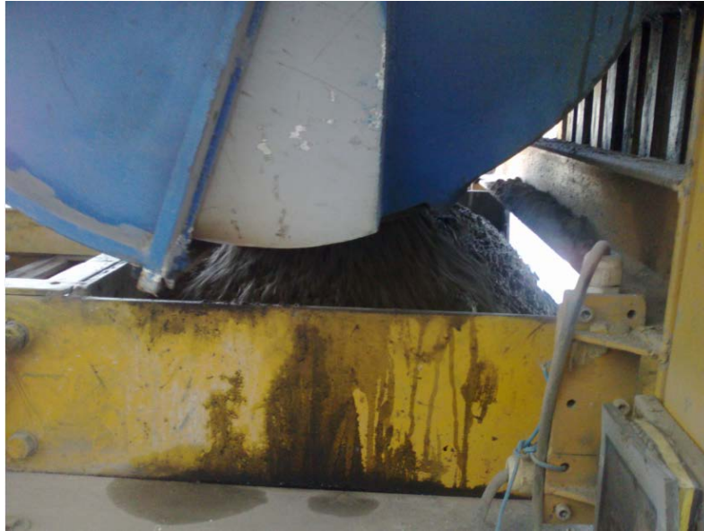
Figura 1.27. Dosificador siendo llenado por la tolva.
