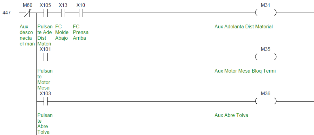
Figura 3.16. Control manual de dosificador, motor de mesa de bloques terminados y apertura de compuerta de tolva.
