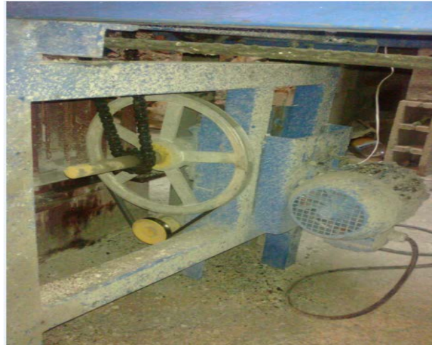
Figura 1.40. Motor que moviliza la mesa 1.
