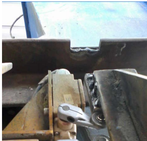
Figura 3.1. Sensor de prensado de bloques (prensa abajo).
