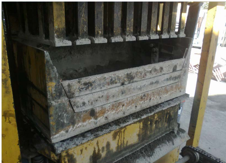
Figura 1.26. Dosificador entre la prensa y el molde.
