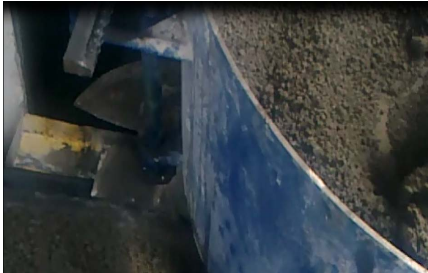
Figura 1.21. Portezuela abierta de la mezcladora.
