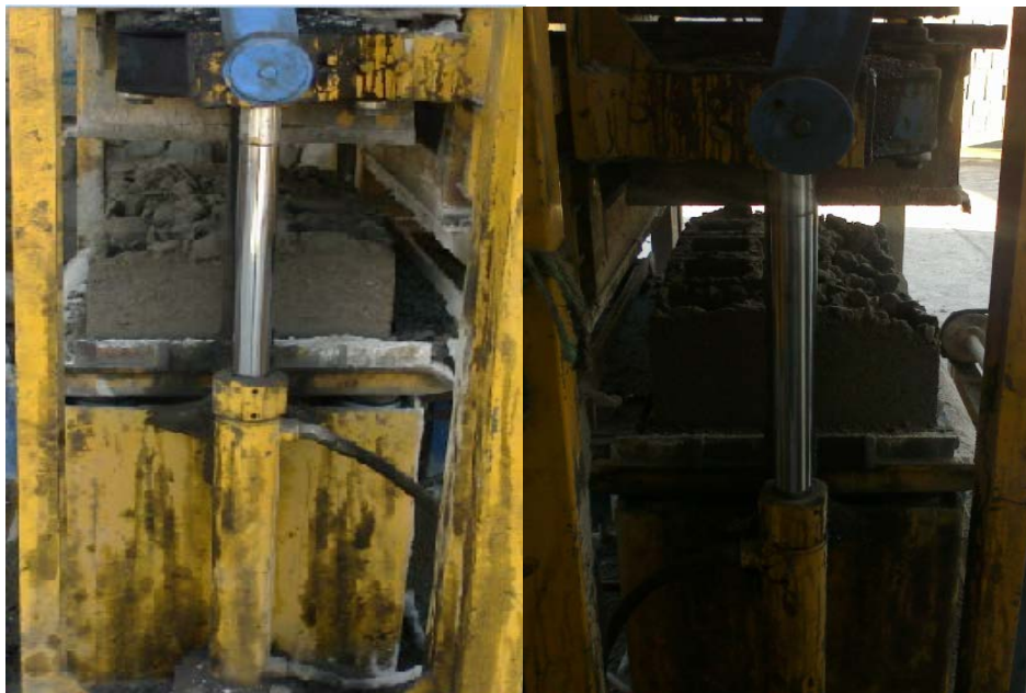
Figura 1.32. Pistones derecho e izquierdo del molde.
