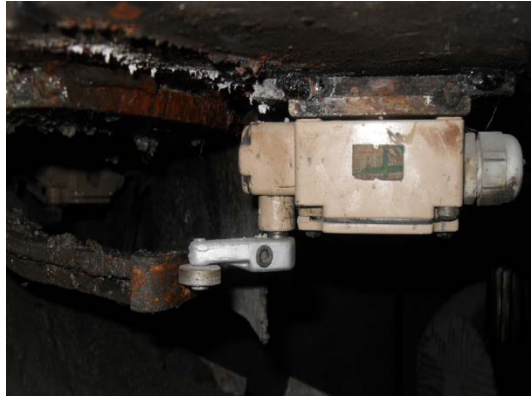
Figura 3.5. Sensor compuerta de la mezcladora cerrada.
