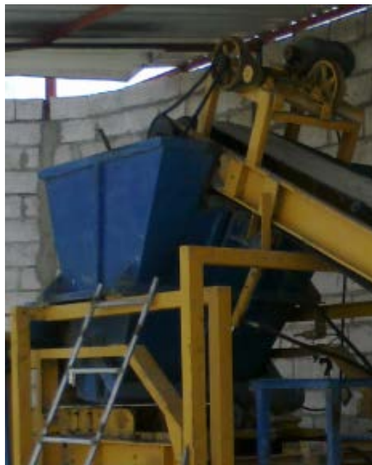
Figura 1.24. Tolva de la máquina bloquera.
