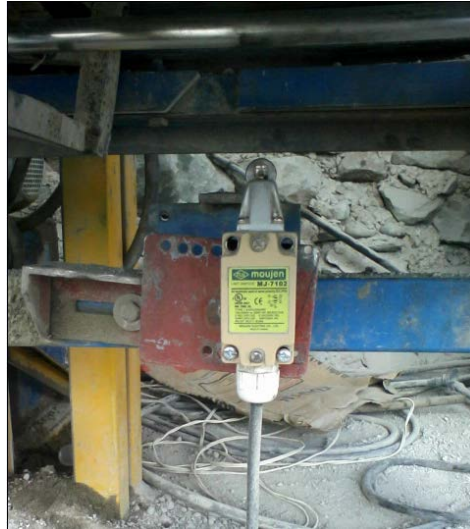
Figura 3.8. Sensor de posicionamiento de tablas atrás.
