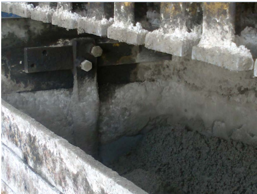
Figura 1.28. Paletas del dosificador.
