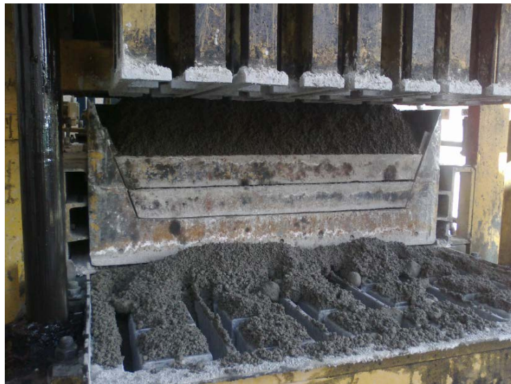
Figura 1.35. Estructura de la prensa en la parte superior.
