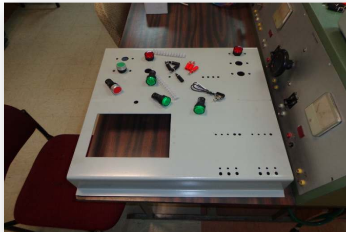
FIG.123 Botoneras, borneras, luces piloto y panel de latón
