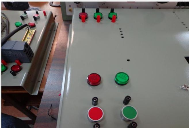
**FIG.128** Montaje de botoneras y luces piloto con sus respectivas borneras
