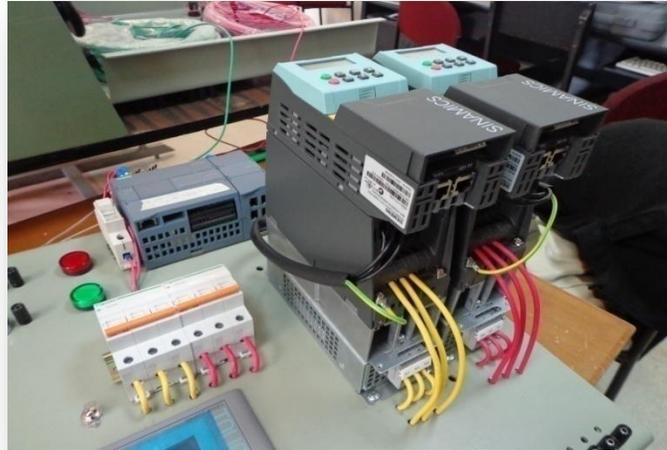
**FIG.139** Conexión de la alimentación de los DRIVES G120
