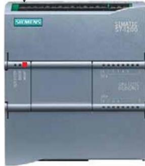
**FIG.147** PLC S7-1200 indicando su estado de error<sup>48</sup>
