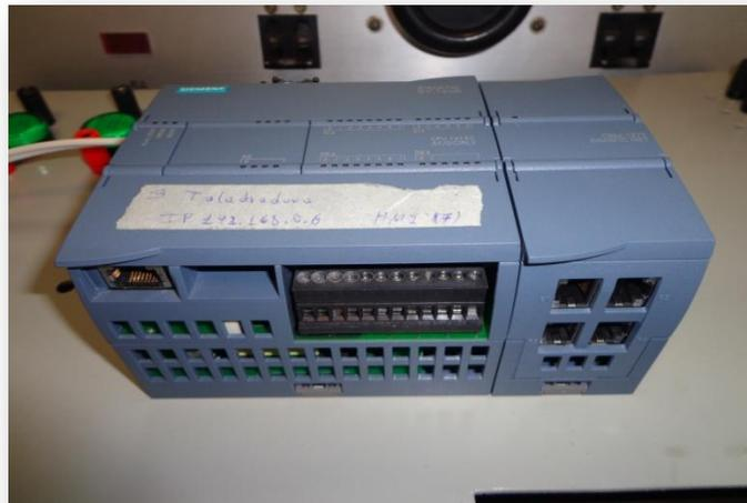
**FIG.124** PLC S7-1200 y Modulo Switch Compacto CSM 1217
