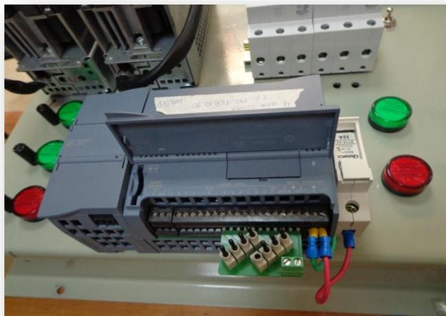
**FIG.138** Conexión de la alimentación de los PLC'S
