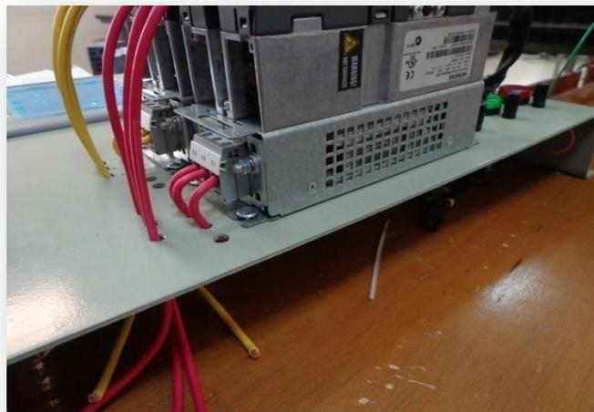
**FIG.134** Montaje de los filtros para el motor
