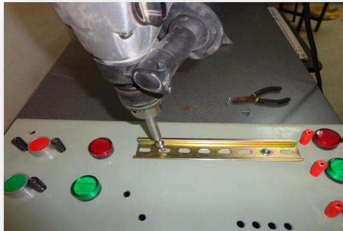
**FIG.127** Montaje del Riel Din
