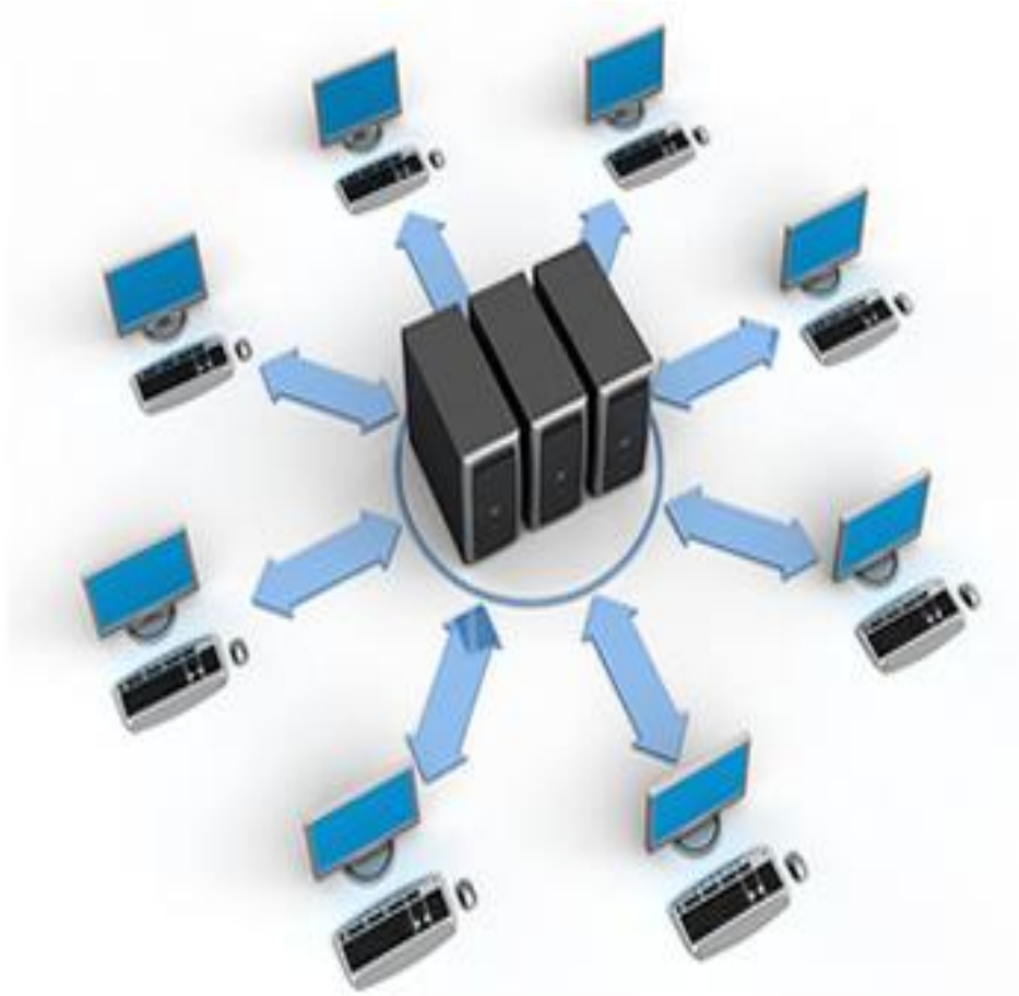
Fig. 1.2 3 Infraestructura de virtualización de escritorios centralizada en el servidor (VDI)
