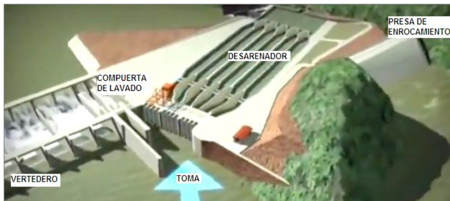
Figura 2.- Esquema de las obras de captación (9)
