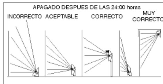
**Figura 2. 2** Ángulos de inclinación de proyectores para iluminar una superficie vertical.
