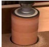
FIGURA 3.13 LIJADORA DE TUPI
