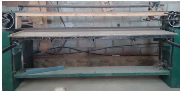
FIGURA 3.15 LIJADORA DE BANDA
