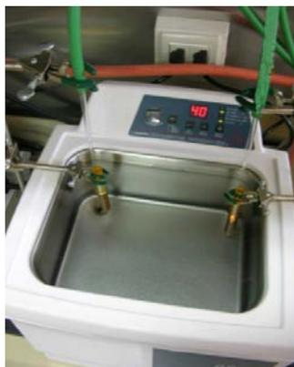
**Anexo 3:** Eliminación del solvente con nitrógeno en baño ultrasónico
