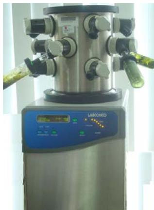
**Anexo 4:** Disposición de los extractos hidroalcohólicos en el liofilizador.
