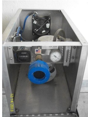
Figura 7. Equipo de muestreo de bajo caudal F y J modelo LV-2.
