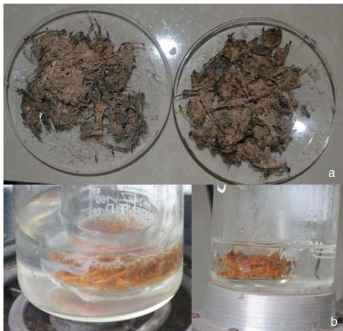
Figura 28. Determinación de celulosa. a. Muestras de pseudotallo y tallo floral. b. Inicio de la extracción con \text{HNO}_3 y etanol
