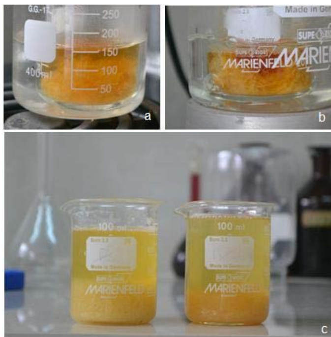
Figura 29. Etapa final extracción de celulosa a. Pseudotallo. b. Tallo floral. c. Tratamiento con 25 ml de KOH al 1% antes de filtrar.
