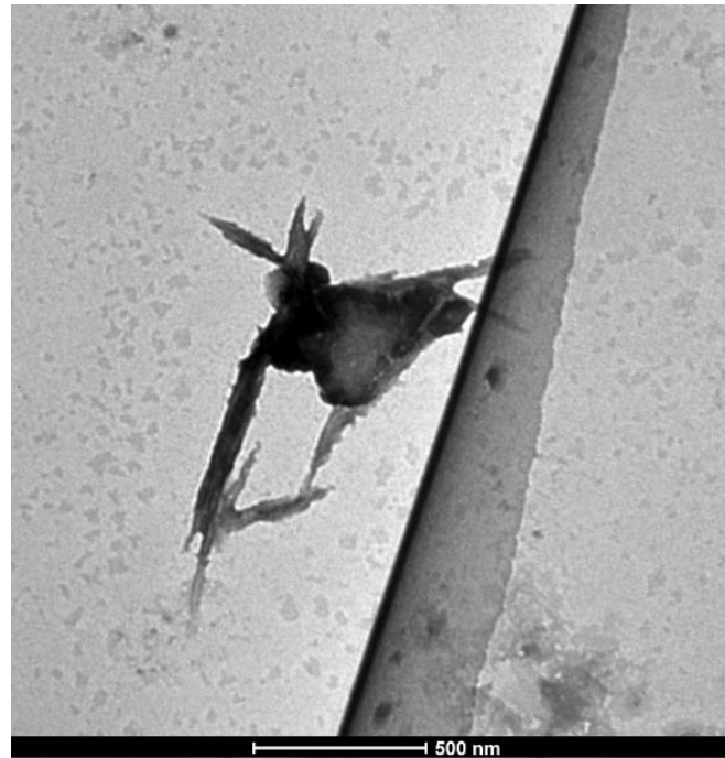
Figura 40. Fotografía en la que se observa la rotura de la película de soporte.
