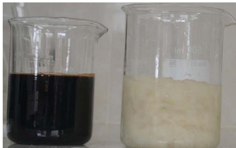
Figura 33. Lignina removida y celulosa blanqueada.
