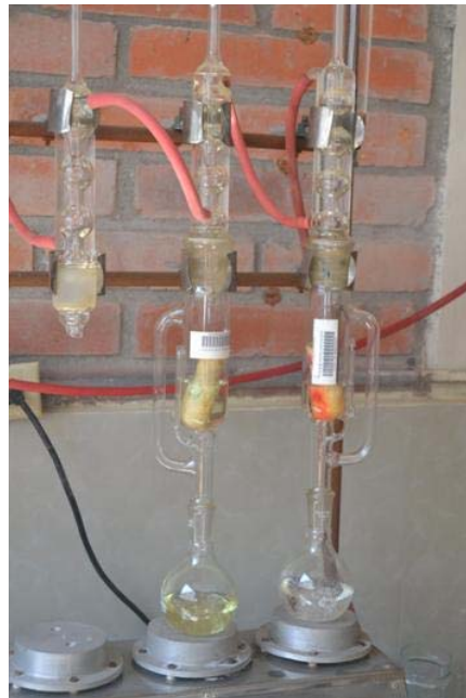
Figura 24. Determinación de elementos solubles en benceno etanol.
