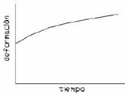
Ilustración 29 Curva de flujo plástico (carga o esfuerzo constante)
