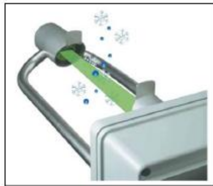
Figura 2.2.2: Principio de medición del disdrómetro
