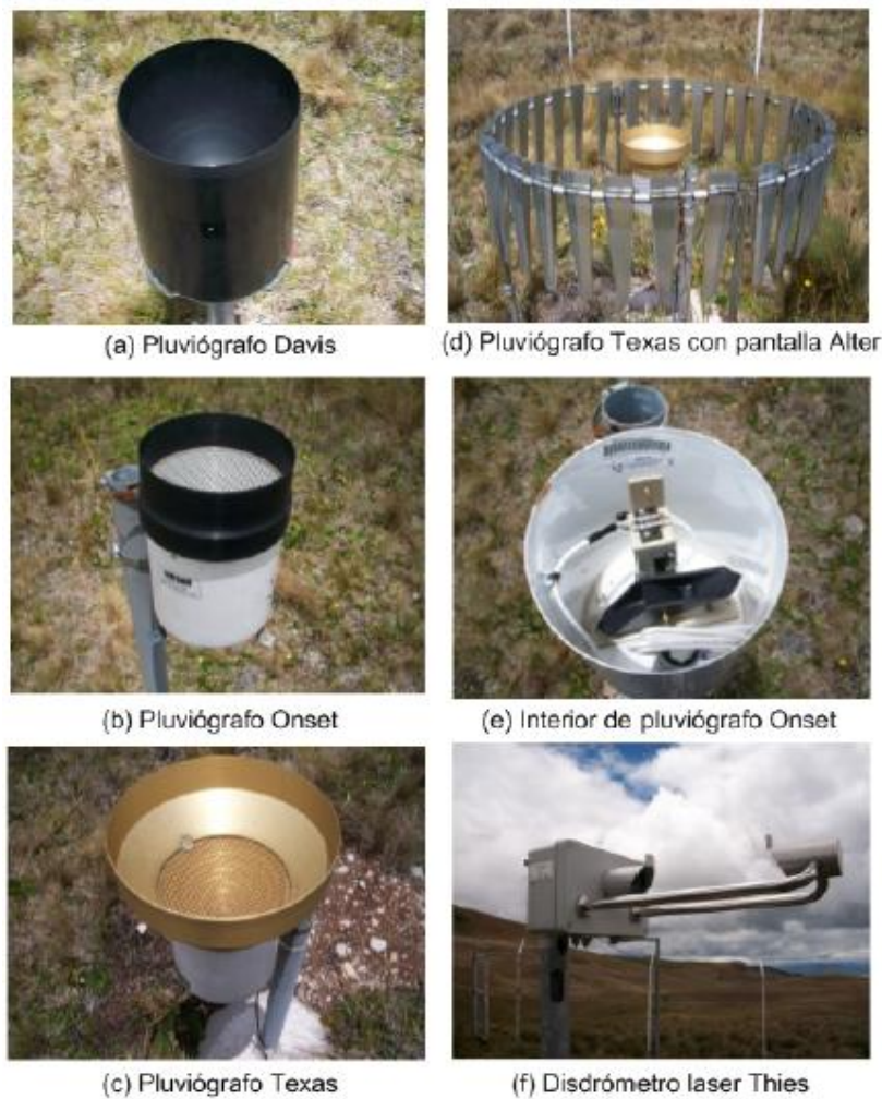
Figura 2.2.1: Sensores de precipitación utilizados
