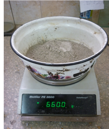
| PESO DE MATERIALES _ CEMENTO (Imagen 26)
