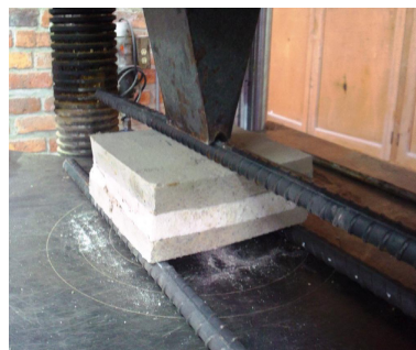
| PRUEBA DE FLEXIÓN PRISMA 5X20X20 cm (Imagen 86)
