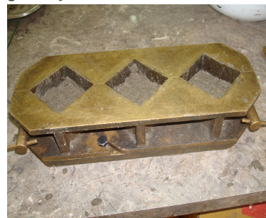
| PRIMERA CAPA DE MEZCLA (Imagen 44)
