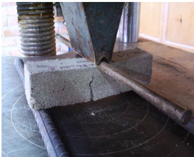
| PRUEBA DE FLEXIÓN PRISMA 4X4X16 cm (Imagen 85)
