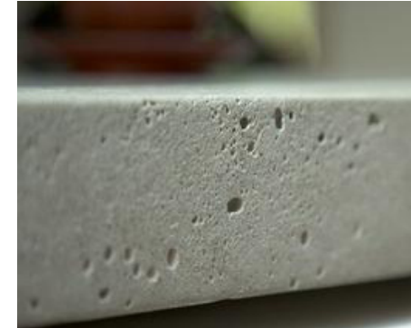
|TEXTURA DE HORMIGÓN CON AGREGADOS LIVIANOS (Imagen 20)
