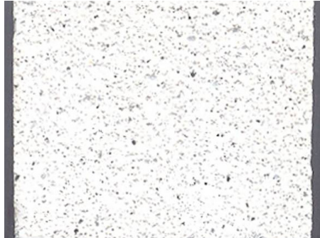
|TEXTURA DE HORMIGÓN SIN FINOS (Imagen 19)
