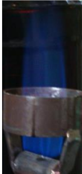
Figura 23. Características de la flama obtenida de la combustión del biogás generado.
