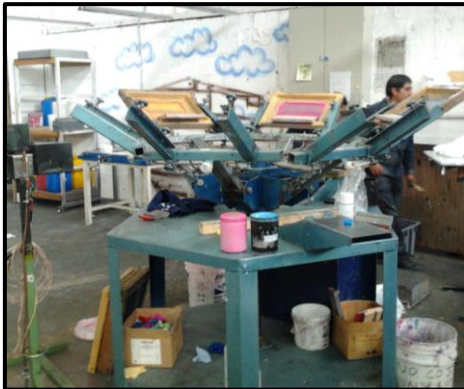
FOTOGRAFÍA N°5: Máquina Pulpo Manual FUENTE: Empresa Pasamanería S.A.
