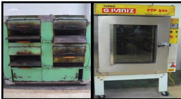
Ilustración 28: Horno convencional Sumbita y horno a convección G. Paniz Autor: Valeria Ulloa y Andres Barzallo Fecha: 5 de diciembre del 2012
