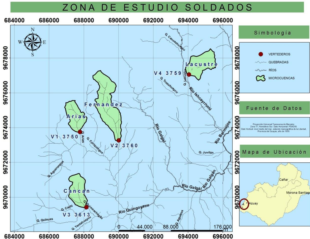
Figura 1. 2 Ubicación del área de estudio y sitios de monitoreo de caudal en la subcuenca del río Soldados. En cada estación hidrológica (V) se coloca la altura sobre el nivel del mar para tener referencia de la presión atmosférica en cada punto.
