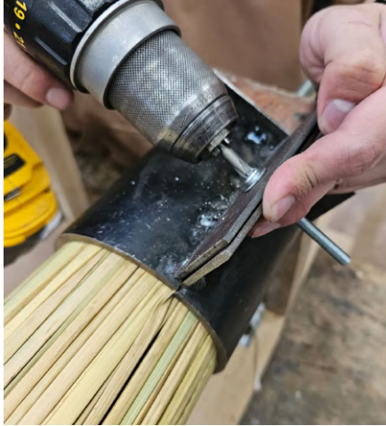
Figura 28. Unión de placas.
