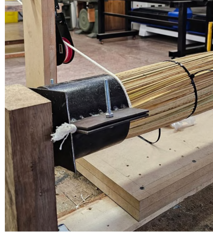
Figura 29. Sujeción de piola de amarre.
