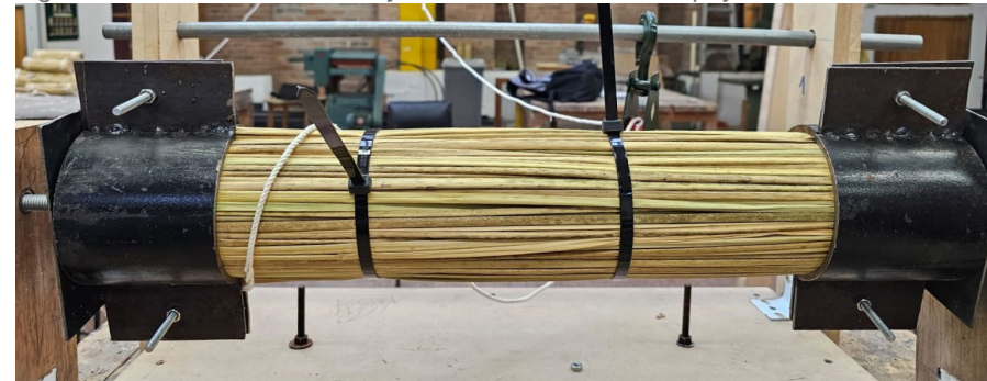
Figura 27. Colocación de fibras y ubicación de bridas de apoyo.
