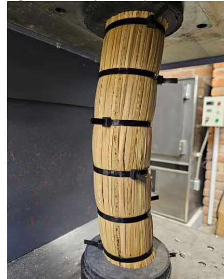
Figura 34. Ensayo a compresión.
