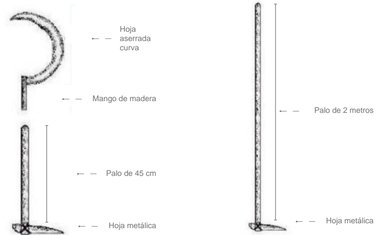
Figura 08. Herramientas utilizadas en la cosecha de totora.
