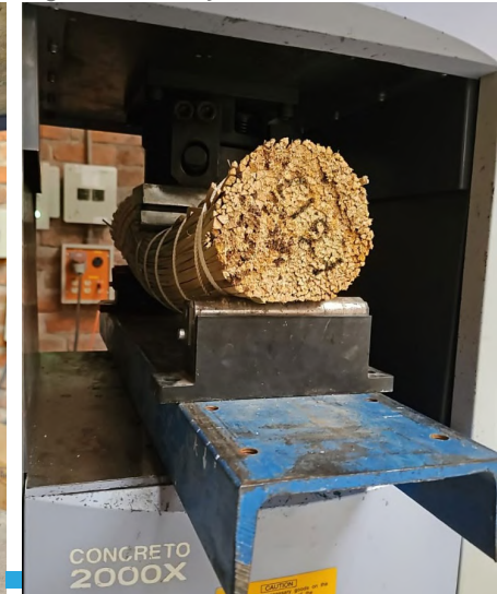
Figura 35. Ensayo a flexión.
