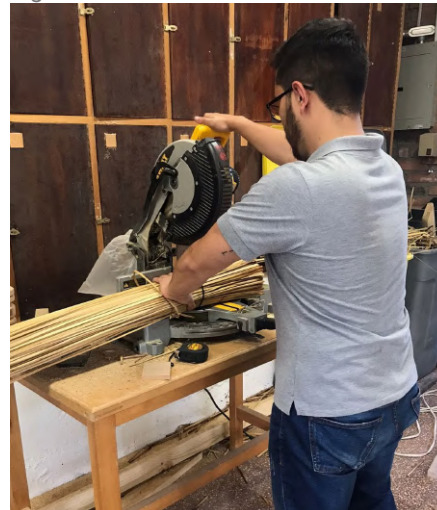
Figura 14. Corte de extremos.
