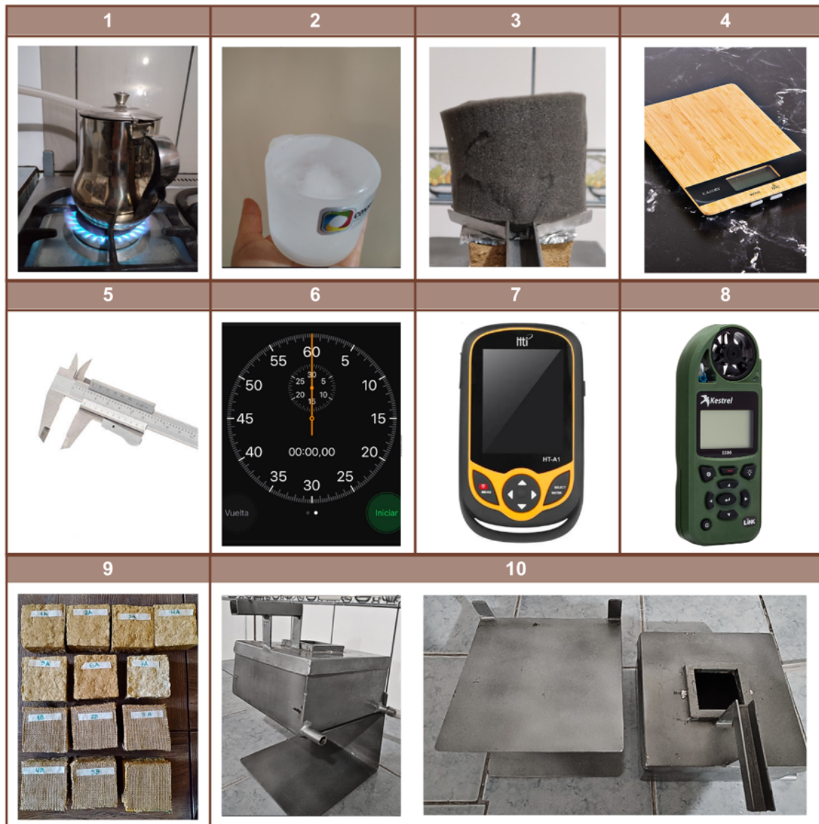
Figura 41: Materiales para la prueba de conductividad térmica mediante la metodología de los aparatos PASCO TD-8561.
