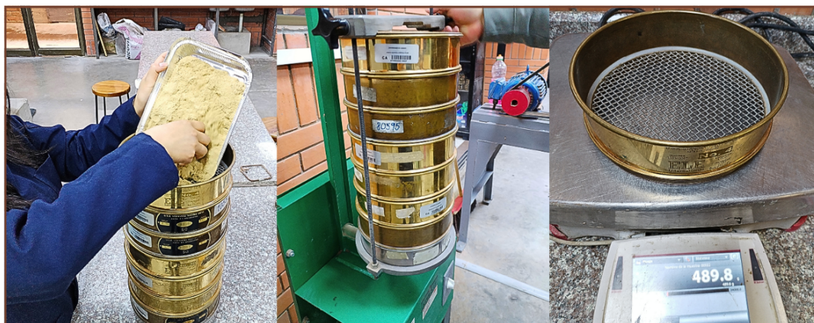
Figura 29: Proceso para el tamizado de fibras de totora y cabuya.
