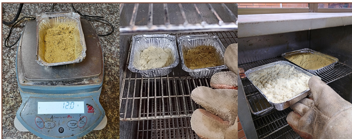
Figura 27: Aplicación de la metodología para la prueba de absorción de humedad.
