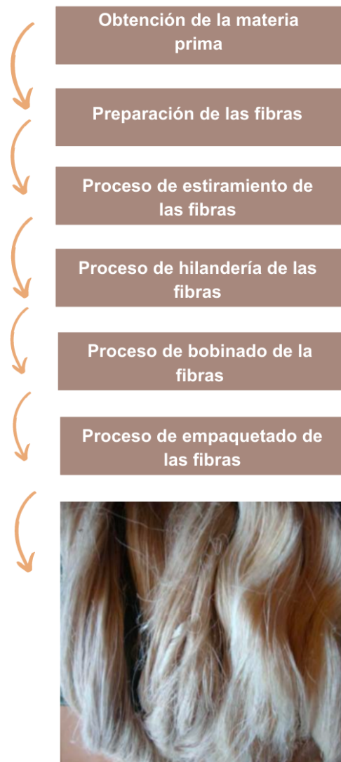
Figura 6: Proceso para la obtención de los hilos de cabuya.
