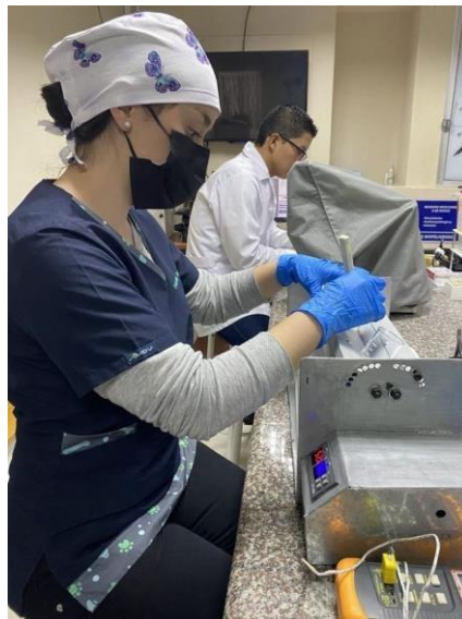
Anexo F. Proceso de calentamiento de muestras vitrificadas en pellets mediante dispositivo de calentamiento STC-3008 (de fabricación artesanal).
