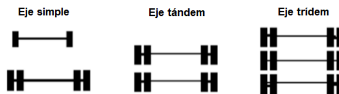
Figura 2.3: Tipos de ejes [7]
