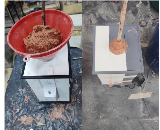
Figura 3 .3 Vertido del mortero y varillado.
