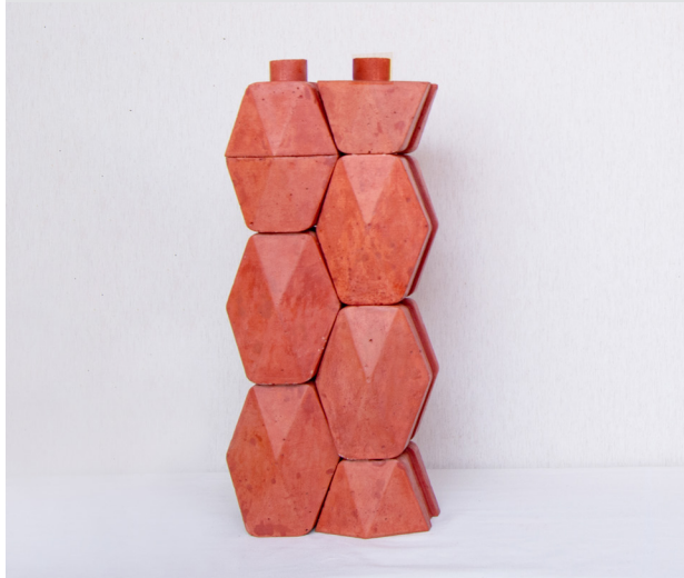
Figura 3.1.4 Armado de una porción de muro en sentido vertical.
