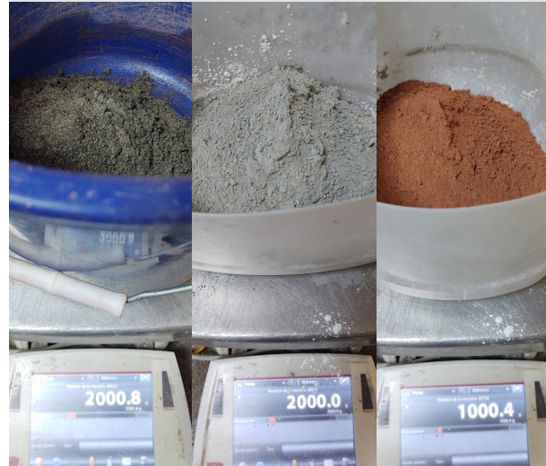
Figura 3 .1 Dosificación del mortero - relación 2:3.
