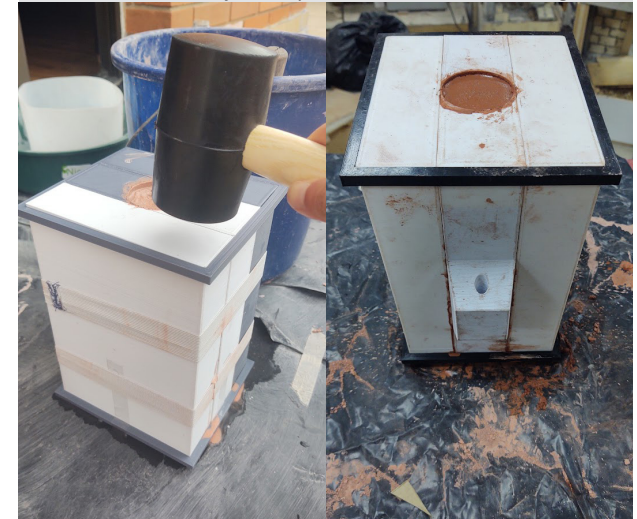
Figura 3 .4 Eliminación de burbujas o espacios vacíos con mazo de goma.
