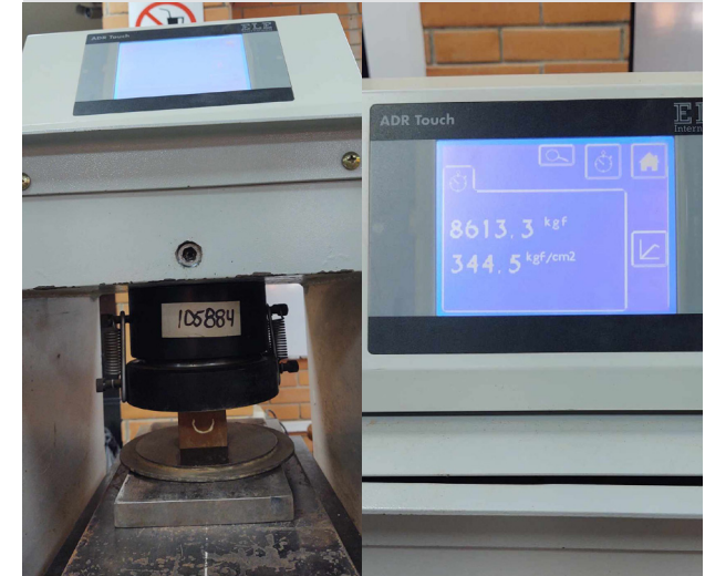
Figura 3.7 Prueba de compresión a los 28 días (Máquina ELE I. modelo 36-0735/02)
