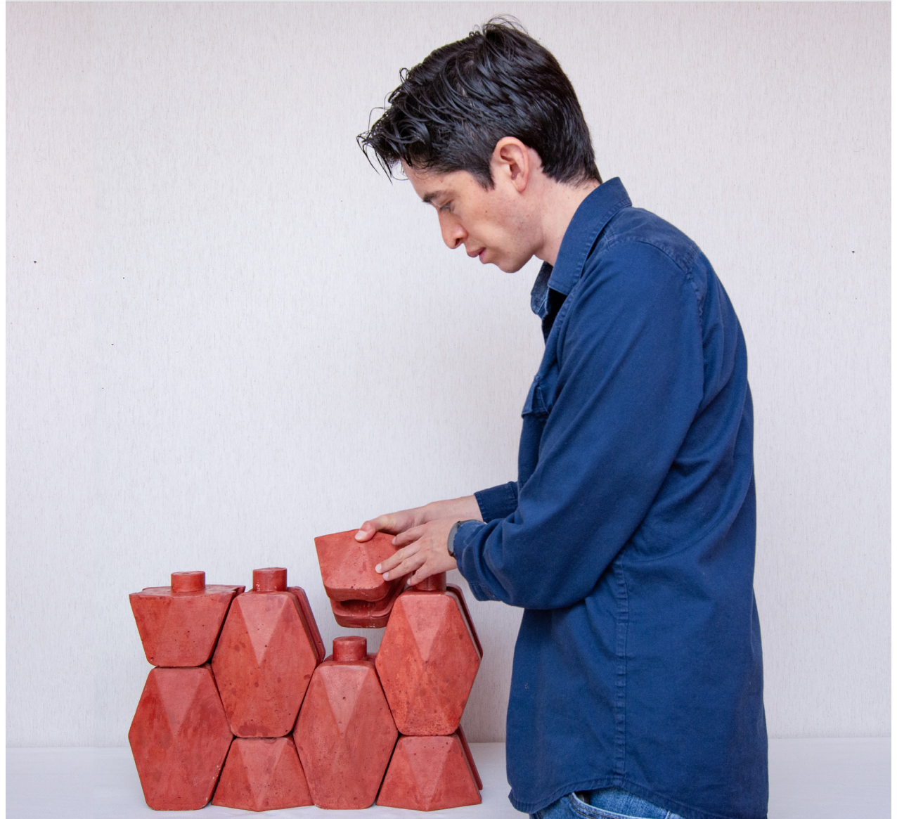
Figura 3.1.6 Armado de una porción de muro en sentido horizontal (autor de la tesis)
