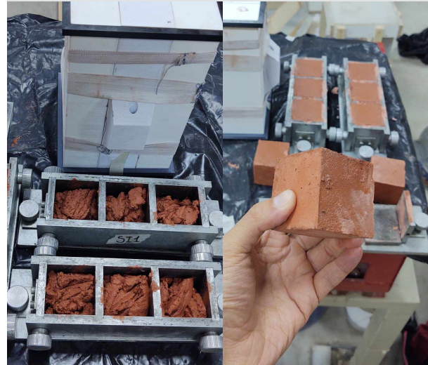
Figura 3.5 Elaboración de probetas de 50mmx50mm.
