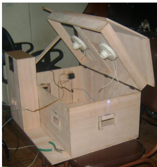
Figura 111. Montaje de servos, luminarias y ventilador.
