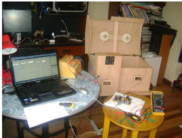
Figura 112. Prueba de placas de potencia para su posterior montaje.
