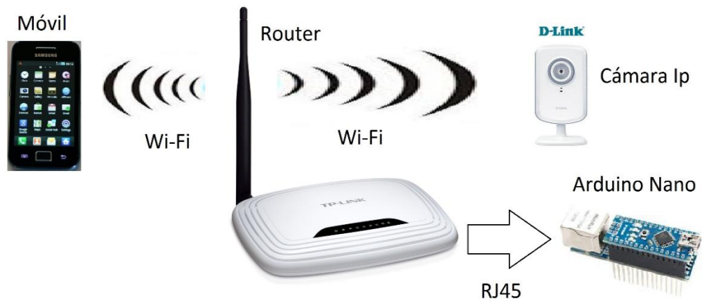
Figura 101. Estructura de la red LAN.
