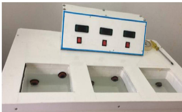
Gráfico 3. Compartimentos de la máquina de termociclado.
