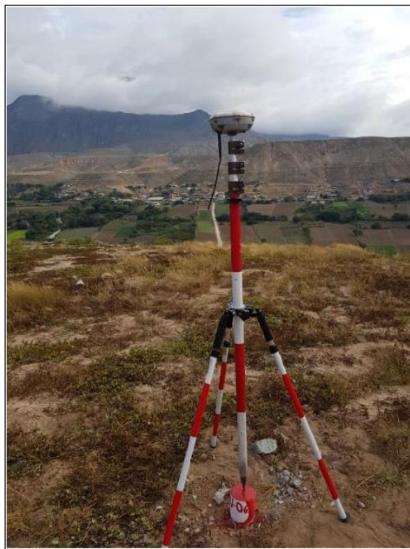
Ilustración 3 Posicionamiento vértices secundarios por RTK Fuente: Ing. Sergio Ortiz
