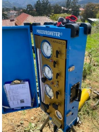
Figura 12. Equipo para ensayo PMT
