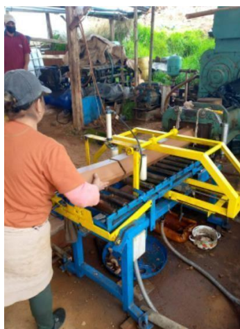
Figura 9. Extrusión de las tejas.
