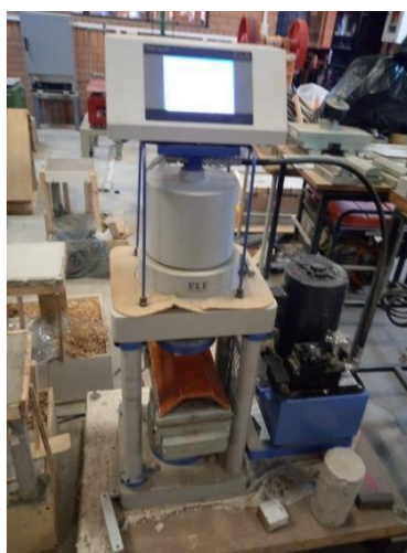
Figura 13. Determinación de la resistencia a la flexión
