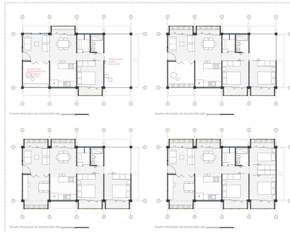
Figura 4.26: Planta de ocupación y progresividad de vivienda tipo
